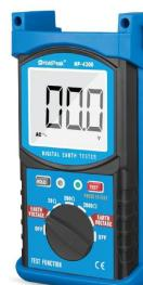
این دستگاه نوآورمند، جهت تست مقادیر مقاومت زمین در انواع تاسیسات مجهز به سیستم ارت، کارایی دارد. سایز بزرگ ارquam و نور پس زمینه اتوماتیک آن که باعث می شود در شرایط نور ناکافی، نور پس زمینه قابل گردد، سادگی و سرعت عمل تست را به همراه می آورد. این تستر توانایی سنجش مقاومت زمین را بر اساس دو روش دو سیمه و سه سیمه دارد. دستگاه به همراه کیف حمل و تمامی متعلقات لازم تحويل می شود.
